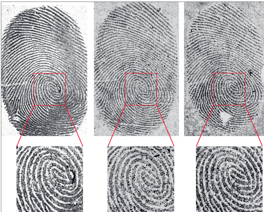
Abb. 2: Natürliche Fingerprints im Alter von (von links nach rechts) 10 Minuten, 1 Stunde und 6 Wochen, mittels Argentorat (Aluminiumpulver) und Gelatinefolie gesichert 2 (Girod-Frais)
